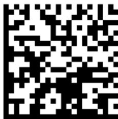
Рис. 3 – Образец штрих-кода формата GS1 DataMatrix для маркировки молочной продукции
