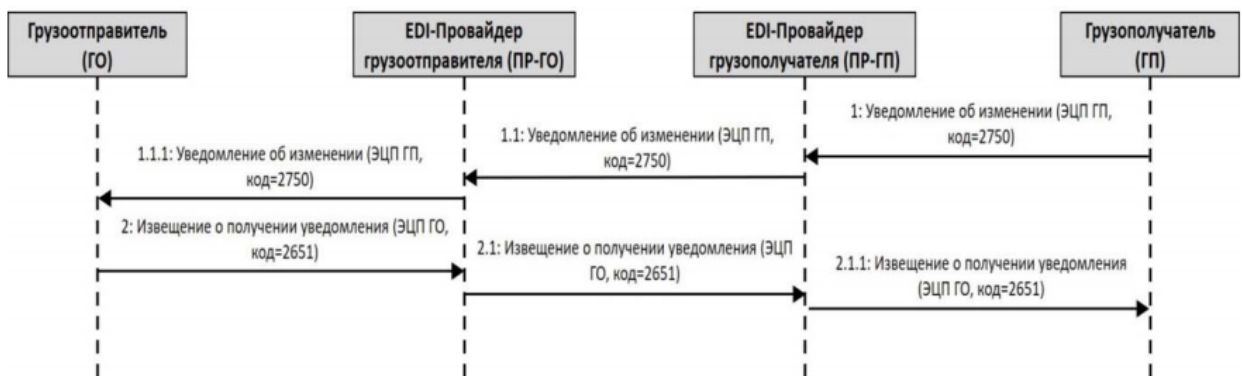
Рисунок 3.6 – Диаграмма последовательности отмены ЭТН грузоотправителем (один EDI-провайдер)
